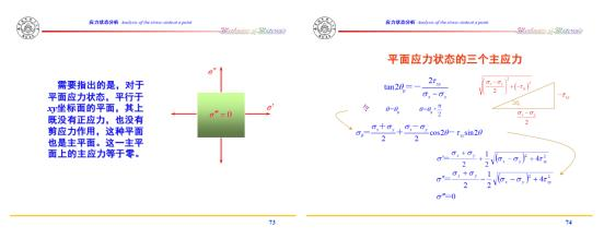
主应力在应力状态分析、一般应力状态下强度设计准则建立方面至关重要。 根据主应力的大小与方向可以确定材料何时发生失效或破坏,确定失效或破坏的 形式。因此,可以说主应力是反映应力状态本质的特征量。
