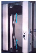
细长压杆稳定性实验
